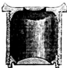
Fig. 27. Durchschnitt einer aus zwei festvereinigten Linsen bestehenden Lupe. (Nach Dippel.)
