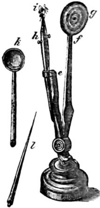
Fig. 51. Zirkelmikroskop, Copie nach Ledermüller.
