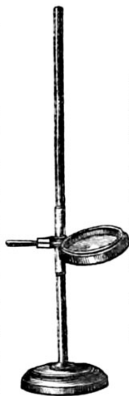
Fig. 28. Einfache Art der Stativlupe. Die Linse ist an dem Stativ mittelst einer Hülse auf und ab, in der Hülse selbst durch eine kurze Stange hin und her zu bewegen.
