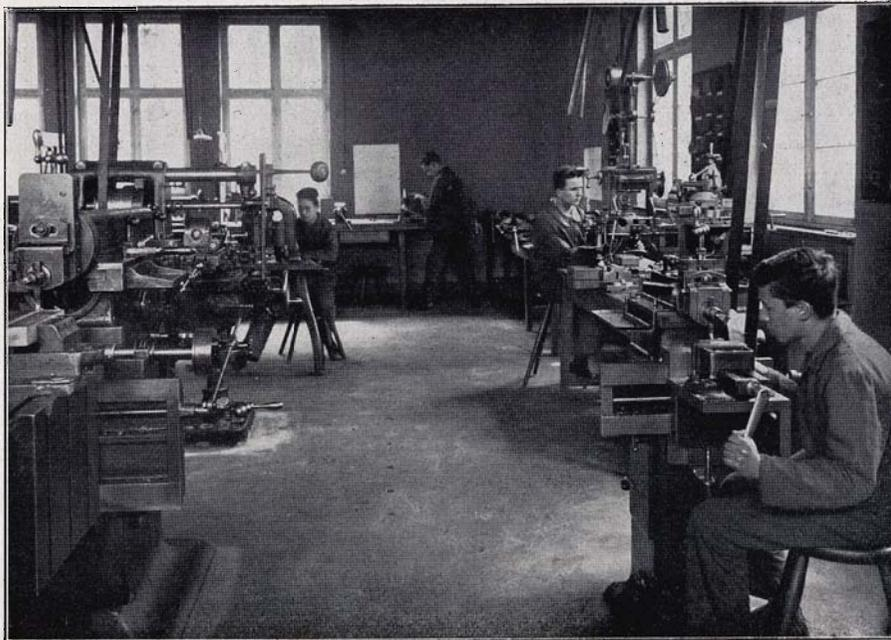
Abb. 13. Hobel- und Fräsmaschinen im Neubau der Mechanikerwerkstatt
