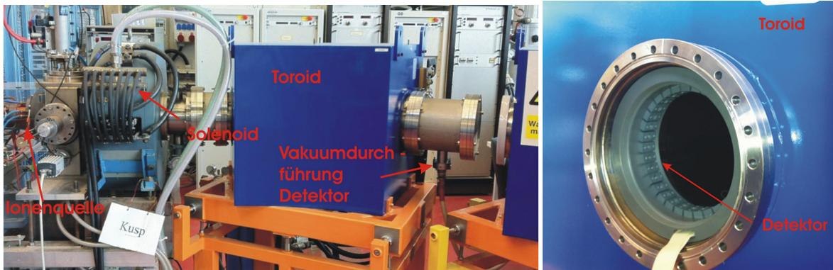
Abbildung 41: Aufbau Strahlexperiment.
