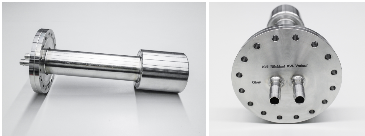
Abbildung 4.2: Statischer Tauchkolbentuner vor der Verkupferung.
