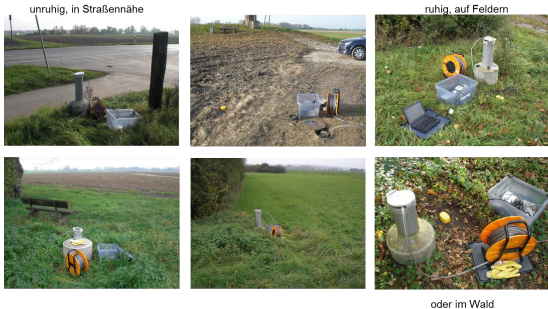
Abb. 3.19: Beispiele verschiedener Grundwassermessstellen, die Teil der kurzzeitigen Rauschmessungen waren.
