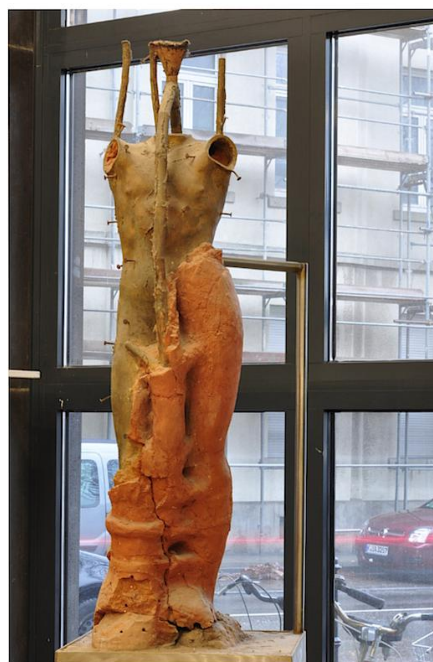
Abb. 20: Rohguss des Betenden Knaben mit teilweise abgeschlagenem Formmantel. Aachen, Gießerei-Institut, Foyer.
