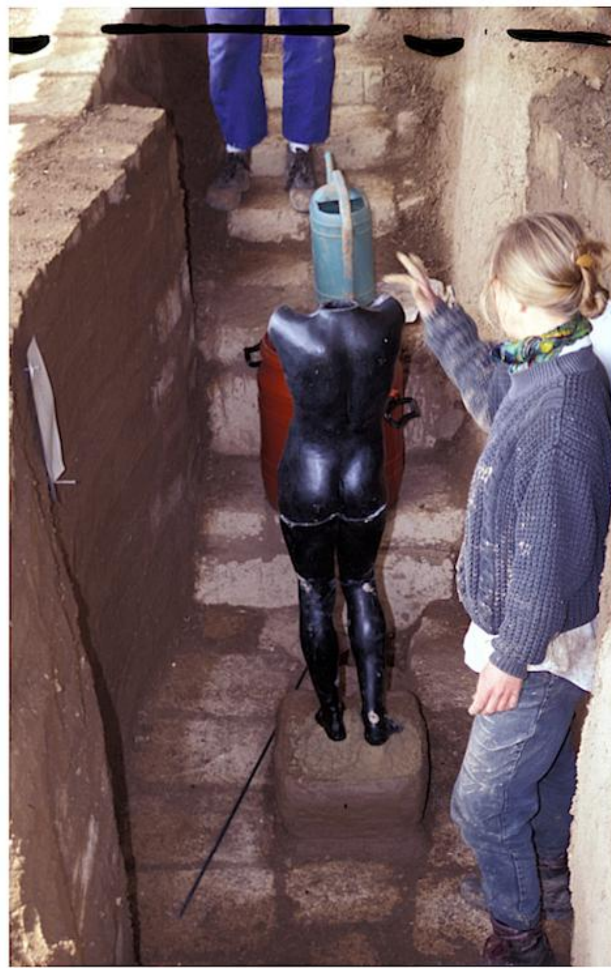
Abb. 11: Aufbau der Wachsform in der Grube. Murlo.
