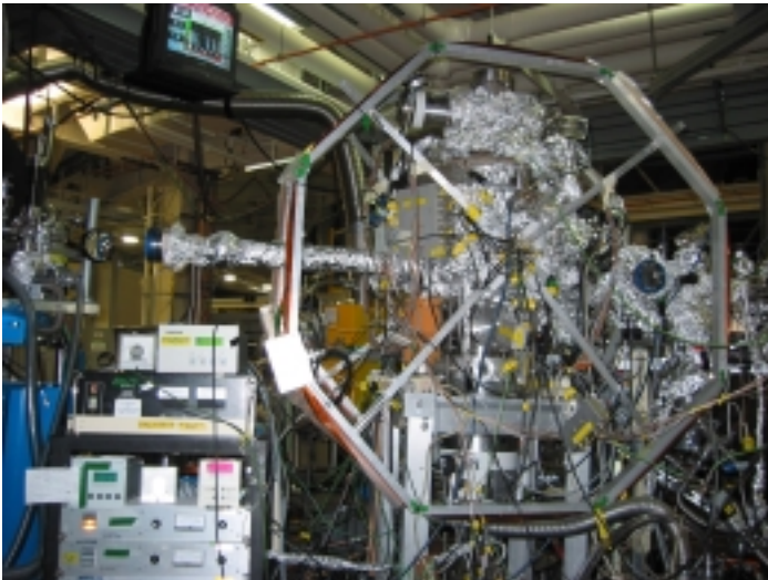
Abbildung A.6: Photographie des experimentellen Aufbaus an der Advanced Light Source (ALS) am Lawrence Berkeley National Laboratory (LBNL). Zu erkennen ist die Hälfte der differentiellen Pumpstufe (rechts), die Quell- und die Experimentierkammer, die zusammen auf einem Aluminiumgestell montiert sind und die Helmholtz-Spulen tragen, sowie das Projektstrahlvernichtungsrohr (links) und die Steuer- und Messgeräte der Turbopumpen und Hochvakuummesszellen.
