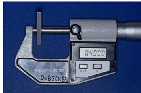
**Abb. 2-9** : Mikrometerschraube mit Endmaß
