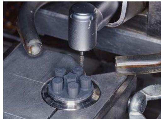
**Abb. 2-24 :** Bearbeitung der Zirkonoxidkeramik
