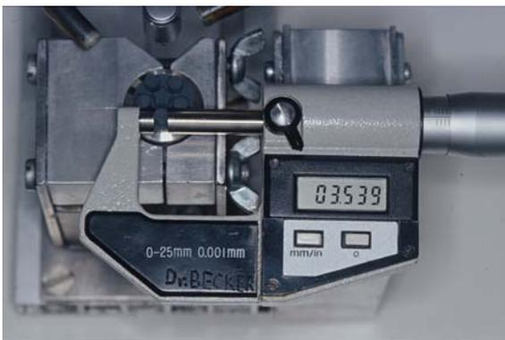
**Abb.: 2-21** : Vermessung der Zirkonoxidkeramikproben
