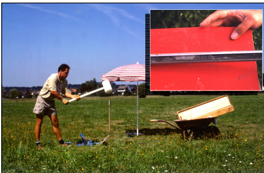
Abb. 21 Nutstangensondierung. Im kleinen Bild oben rechts: graue und hellgraue LST-Ablagerungen, im Liegenden (rechte Seite, dunkelgrau) der obere Teil des spätglazialen Bodens.
