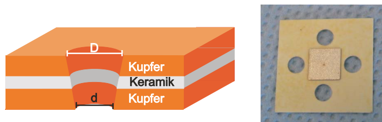
Abbildung 2.21: Schema und Foto einer Mikrostrukturelektrode (MSE) zur Erzeugung eines Plasma bei Atmosphärendruck [Jah02]
