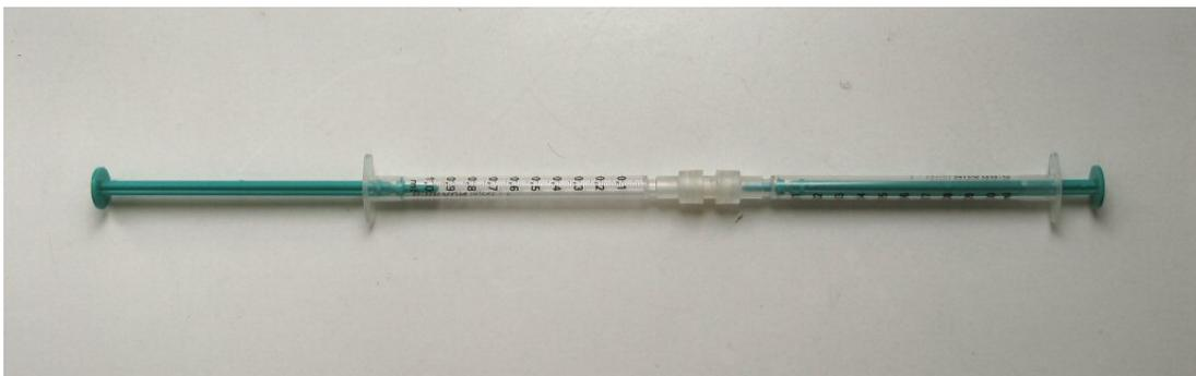
Abbildung 87: 1mL Spritzen auf CPG-Säule zur manuellen Kupplung der Benzimidazolderivate
