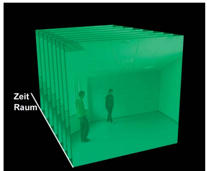
Abb.3: Aus der Sequenz zweidimensionaler Bilder ist ein Würfel entstanden, den man als dreidimensionales Bild auffassen kann. Aus der ehemaligen Zeitachse ist dann eine weitere Raumachse geworden.
