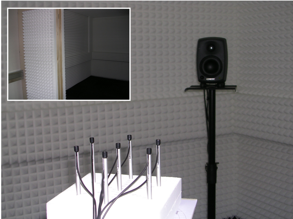
Abbildung 5: Multipol-Array 3.Ordnung in reflexionsarmer Umgebung. Kleines Bild: Zwischenwand und neue, reflexionsarme Auskleidung.
