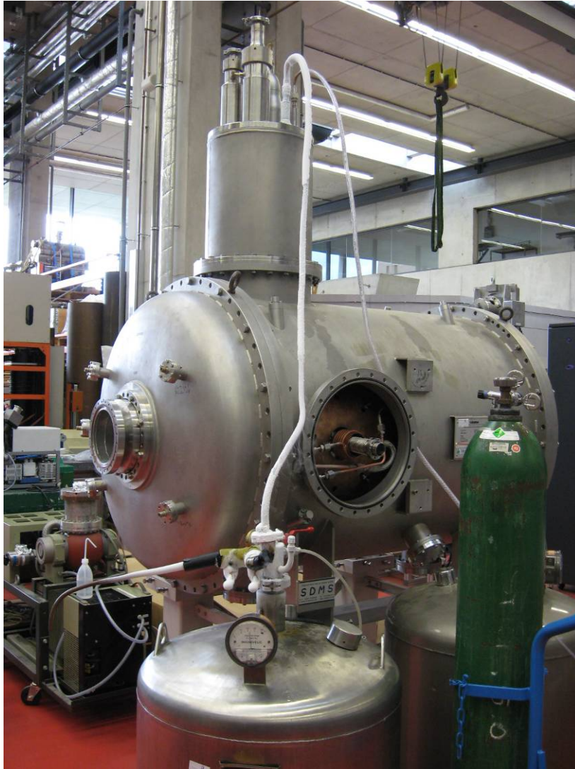
Abbildung 1: Der horizontale Kryostat während des Kalttests mit flüssigem Stickstoff
