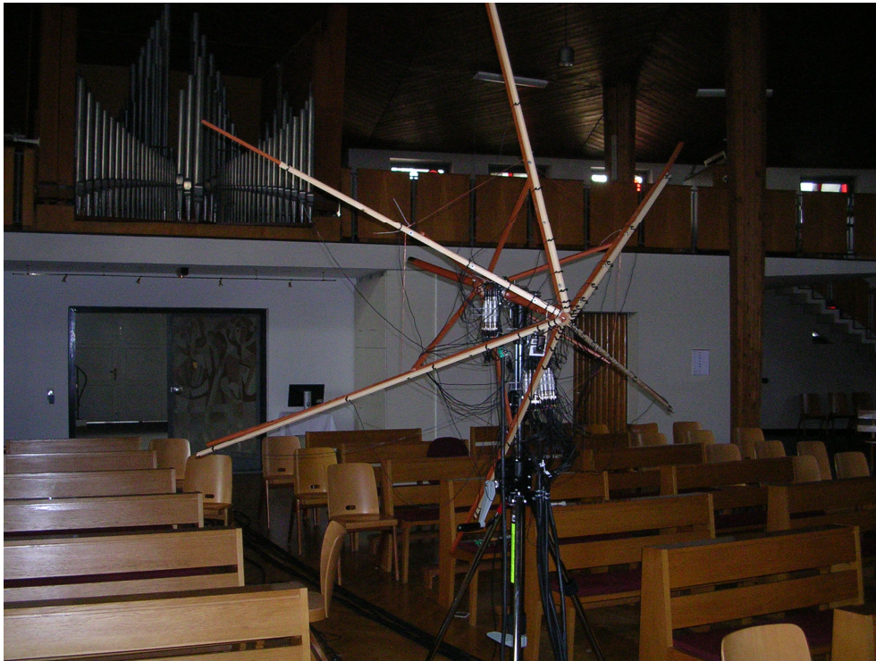
Abbildung 4: Dreidimensionales Mikrofonarray mit 48 Mikrofonen zur Untersuchung eines breitbandigen Constant-Directivity-Beamformers.
