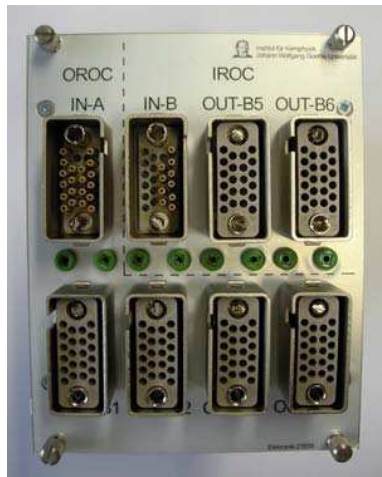
Abb. 9: Frontansicht einer Verteilerkassette
