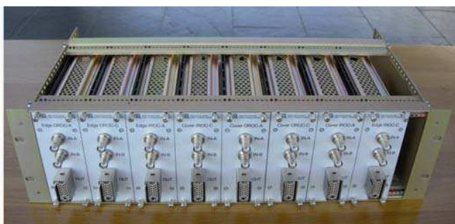
Abb. 11: Fertig aufgebauter HV-Fan-Out Baugruppenträger Literatur
