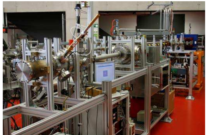
Abbildung 1: Die „FNSR-Testbank“ ist mit einer Penning Ionenquelle sowie mit einem Strahlprofil- u. Emittanzmesssystem 5 (im Vordergrund) ausgestattet.
