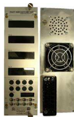
Abb. 14: Fast NIM Ratemeter Frontansicht und Rückwand
