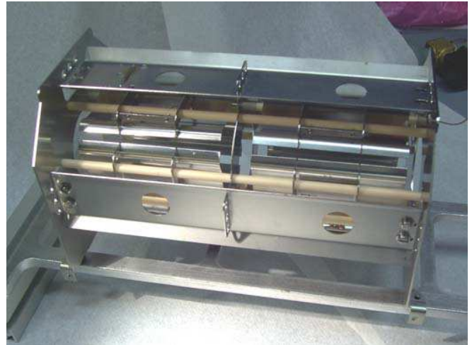
Abbildung 3: Ein Testmodul für ein Quadrupoldublett. Alle Metallteile sind aus UHV-tauglichem Edelstahl mittels Laserschneidens hergestellt. Als Isolatoren dienen Keramikrohre aus Friatlit®.
