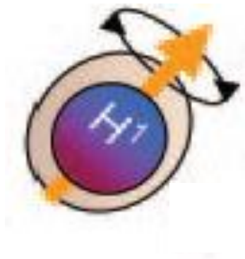
Abbildung 4: Präzessionsbewegung Darstellung der Präzessionsbewegung eines Wasserstoffprotons (aus Bitar et al., 2006).
