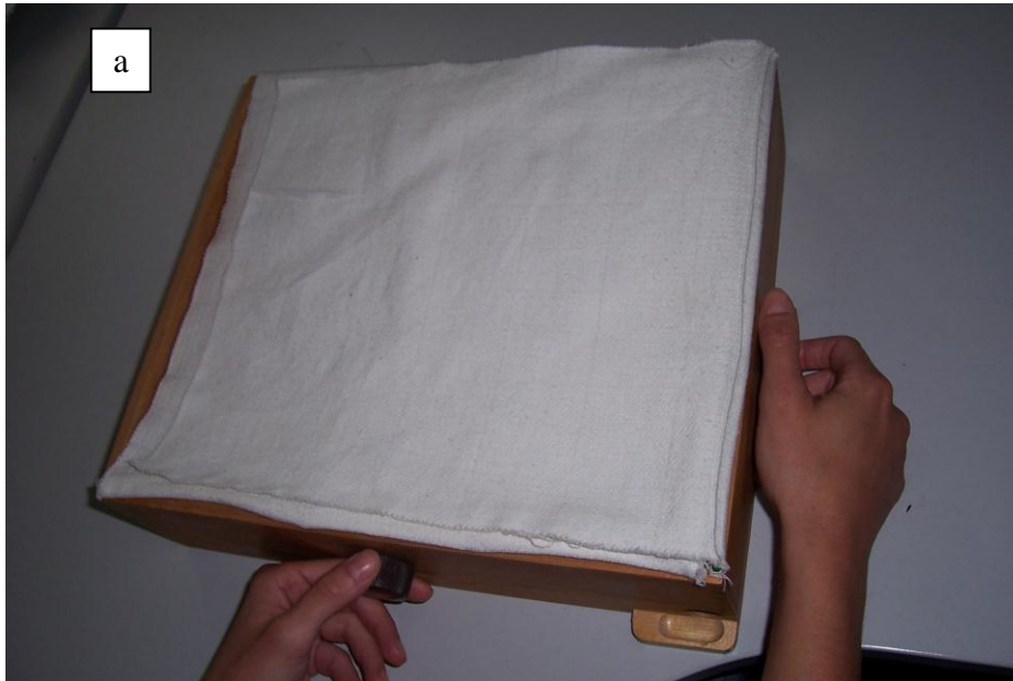
Abbildung 21a: Aufbau für den Labyrinth-Test Die Abbildung zeigt die Position der Hände während des Versuches. Die rechte Hand bewegte das Rädchen, das der Kippung des Brettes nach vorn und nach hinten dient, die linke Hand dasjenige zur Kippung nach links und nach rechts.
