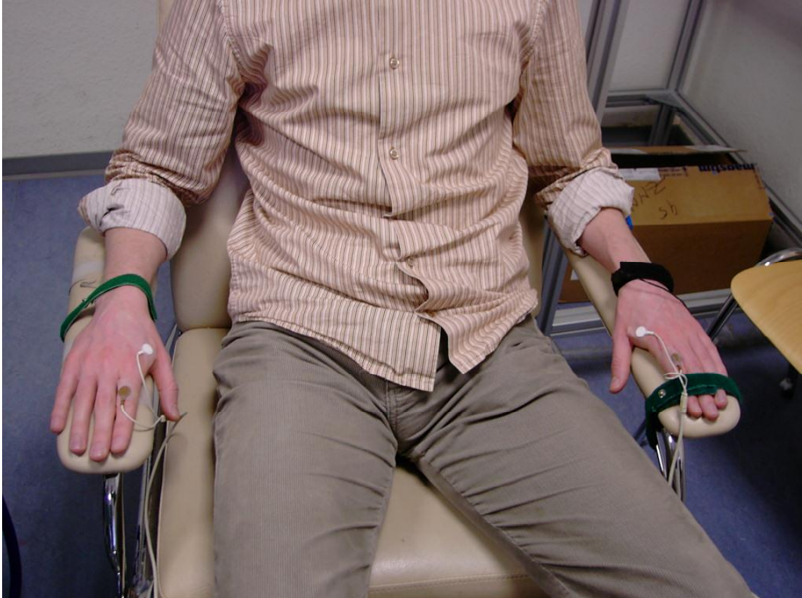
Abbildung 18: Aufbau für die Untersuchung auf Spiegelaktivitäten Die linke Hand wurde in Höhe des Zeigefingers fixiert, um ein Widerlager zu geben, die rechte Hand wurde am Handgelenk fixiert, um ausladende Handbewegungen zu vermeiden.
