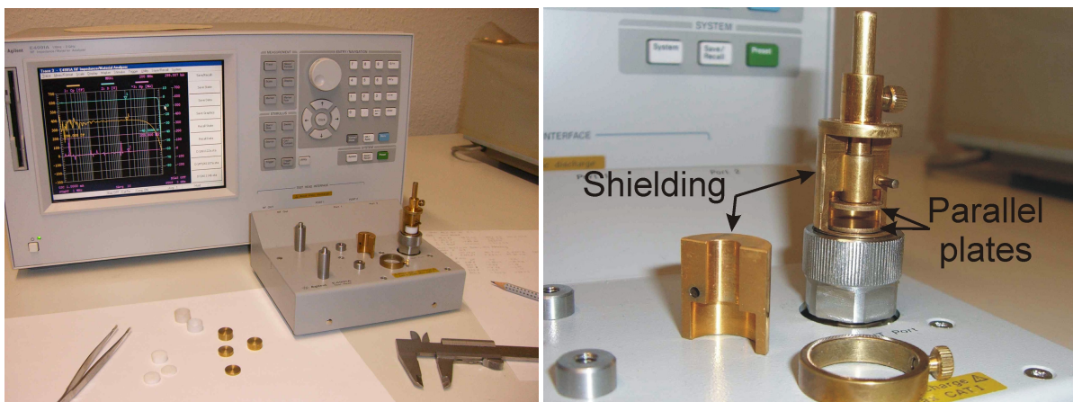
Abb. 4.1: Fotos des Frankfurter DK-Geräts. Links: Impedanzanalysator und Messzelle. Rechts: Messzelle vergrößert; gut sichtbar sind die beiden Kondensatorplatten, zwischen die das zu untersuchende Medium gegeben wird. Zur Messung wird die Schirmung geschlossen.
