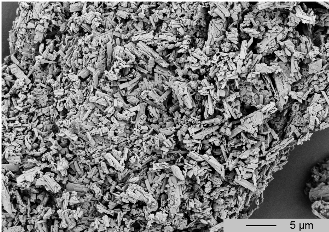
Abbildung 91: Übersichtaufnahme der porösen Struktur eines Agglomerats von Albendazole Mesylat
