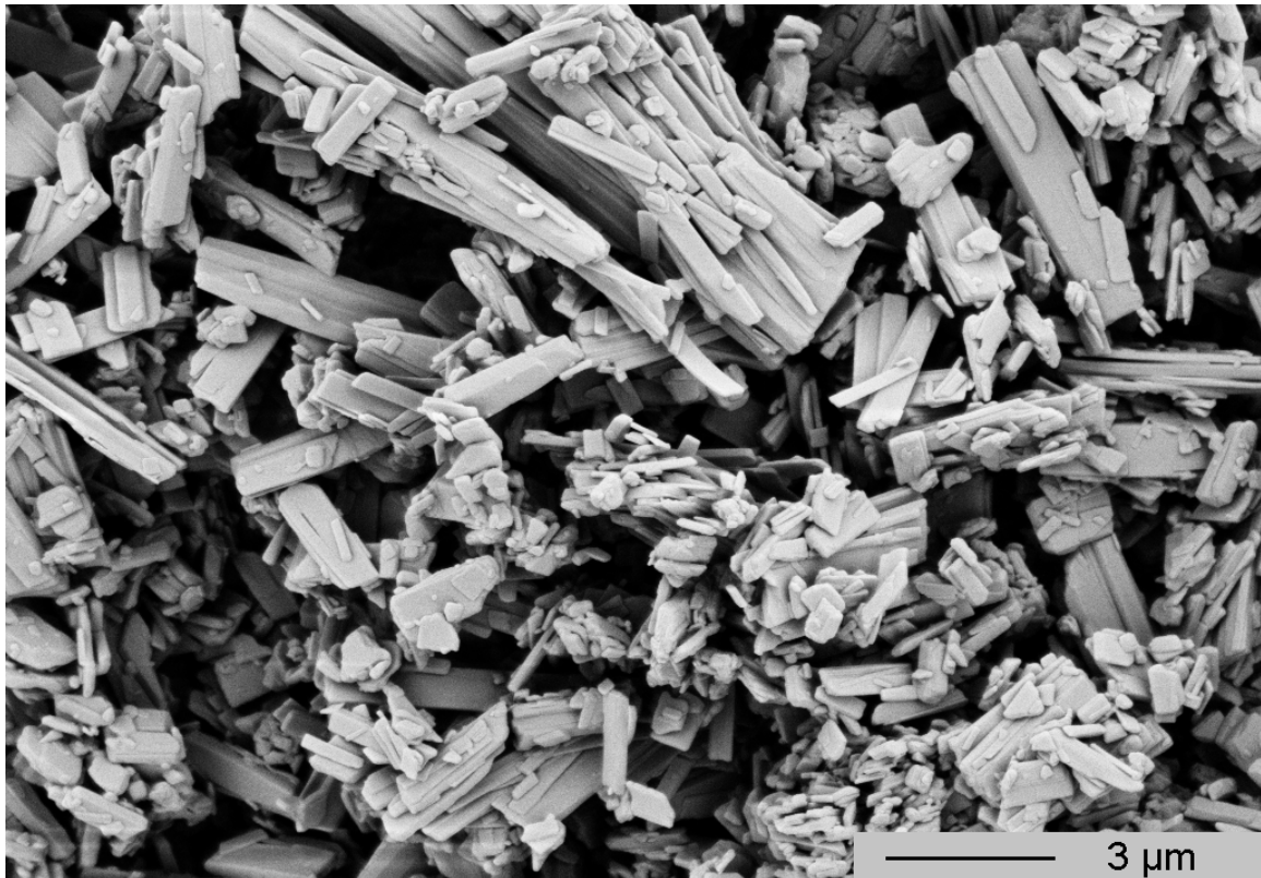
Abbildung 23: REM-Aufnahme von Primärpartikeln von Albendazole Mesylat
