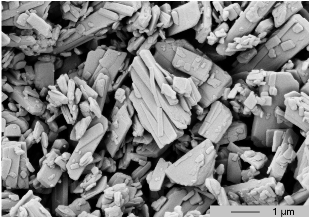
Abbildung 89: Detailaufnahme der feinen Primärpartikel von Albendazole Mesylat
