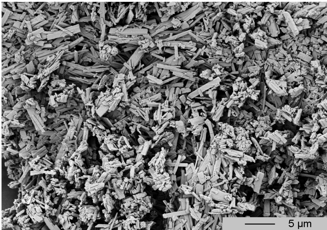
Abbildung 91: Übersichtaufnahme der porösen Struktur eines Agglomerats von Albendazole Mesylat
