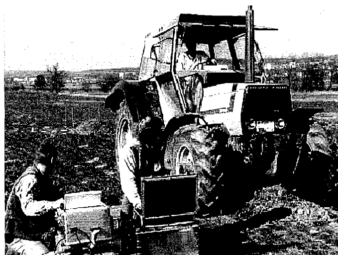
Messungen auf dem Versuchsacker: Während einer Überrollung erfassen Sensoren unter der Fahrspur Druckausbreitung und Bodenverformung.
