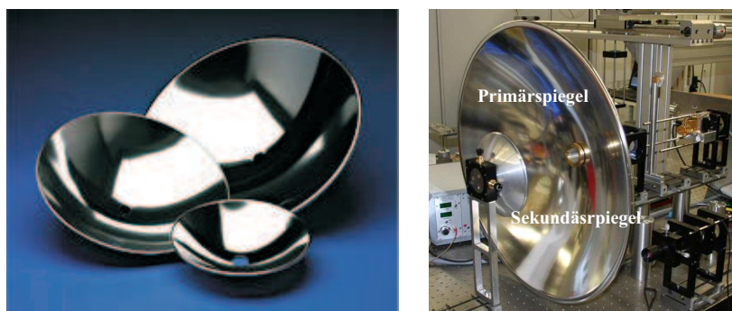
Abb. 3.43: Links: Parabolspiegel der Firma Edmund Optics [47]; Rechts: Mechanikdesign für das quasioptische Scansystem III
