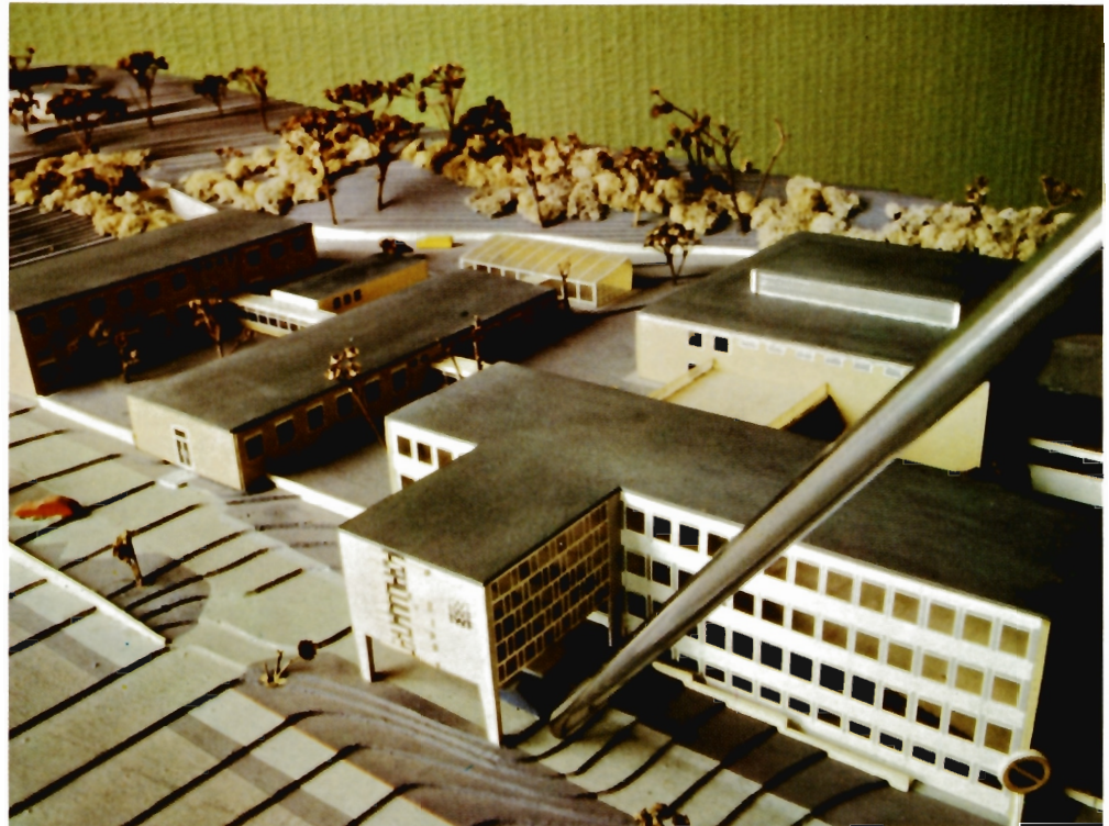
Abb. 44: Die Spazierfahrt mit dem Endoskop durch Architekturmodelle vermittelt den Blickwinkel aus der Fußgängerperspektive – hier an einem Modell des IWF-Gebäudes demonstriert
