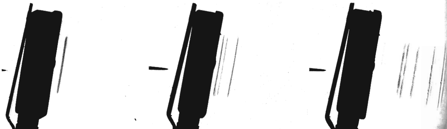
Bild 2: Sichtbarmachung von Ultraschallwellen. Die Aufnahmen zeigen die Ablösung von Ultraschallwellen von einem Schallsender, der sich unter Wasser befindet. Sie wurden mit Hilfe der Schlierenmethode sichtbar gemacht. Der zeitliche Abstand der einzelnen Bildphasen betrug \frac{1}{500.000} Sekunde; im üblichen Sprachgebrauch entspricht das einer Aufnahme Frequenz von 500.000 B/sec.
