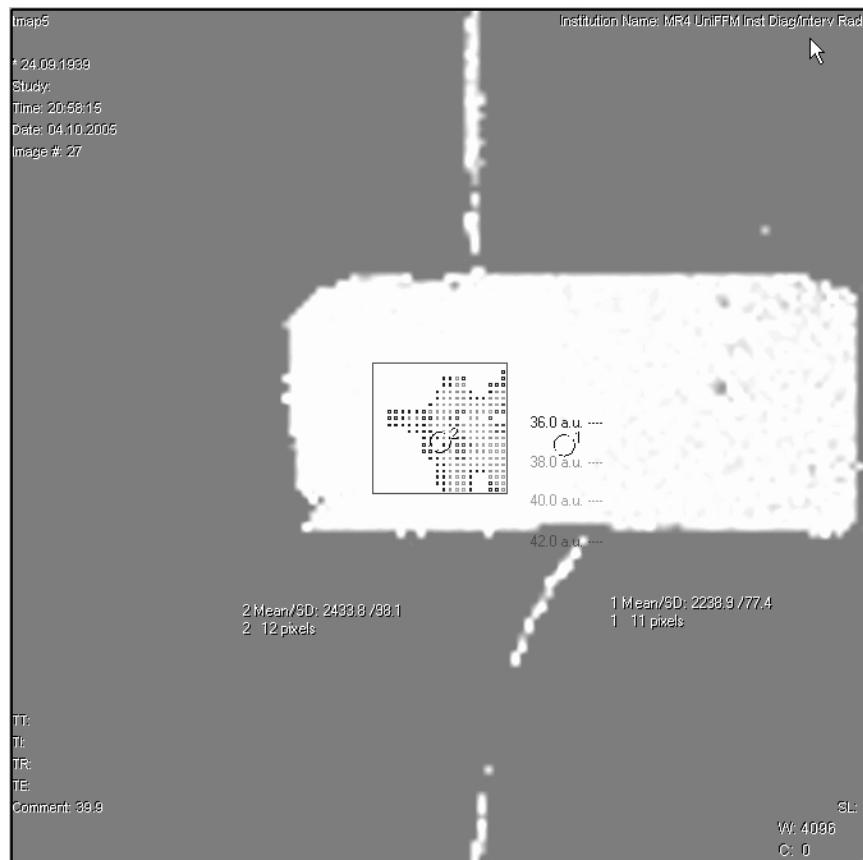
Abbildung 3.9: Phasemapping mit dem Siemens WIP Paket. Die Temperaturen werden im gewählten Rechteck farbkodiert wiedergegeben. Die vier zur Verfügung stehenden Temperaturbereiche werden vorher festgelegt.
