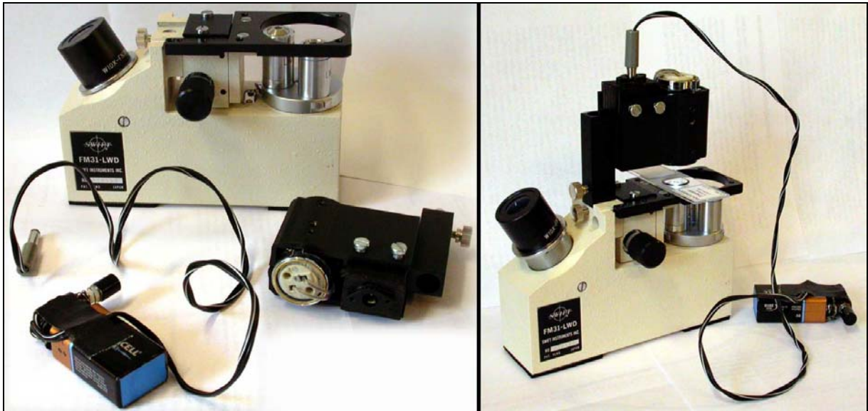
Abbildung 1: SWIFT FM31 mit LED-Beleuchtung. Das Okular wird ausgezogen und rastet ein. Die Objekte werden von unten betrachtet.
