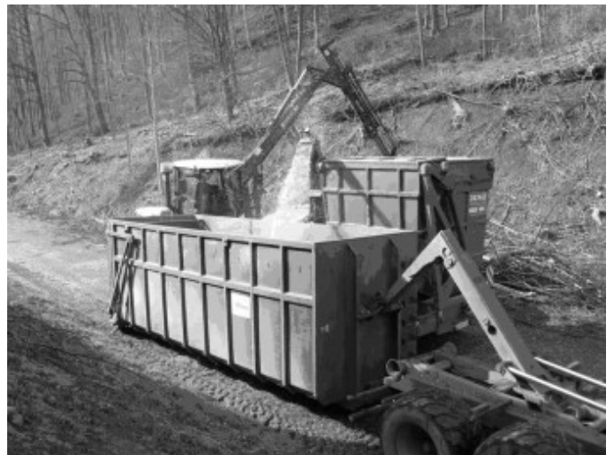
Abb. 6: Kronenschnitt und Schwachholz werden direkt vor Ort - hier am Rande der Modellfläche NSG "Ziegenberg" - gehackt (Trommelhacker). Die gewonnenen Hackschnitzel werden in Containern abtransportiert und vermarktet. (Foto: Frank GRAWE)
