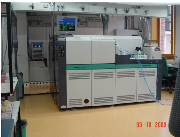
Abb.10.5 Das ICP – MC MS (Neptune, Finnigan MAT) des Instituts für Geowissenschaften, Fachinheit Mineralogie der Goethe-Universität Frankfurt am Main.
