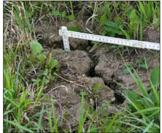
Abb. 10: Schumpfrisse auf der Probefläche 91 im Roßlauer Oberluch (Sommer 2008).
