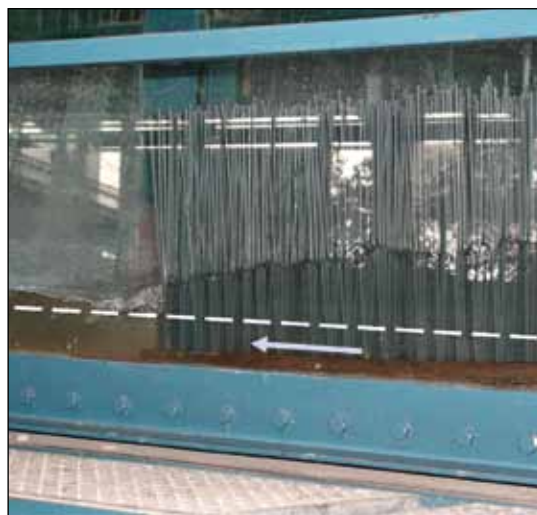
Abb. 6b: Effekt von Hindernissen in der Abflussrinne auf die Hydraulik des Wassers. Foto: S. Schneider.
