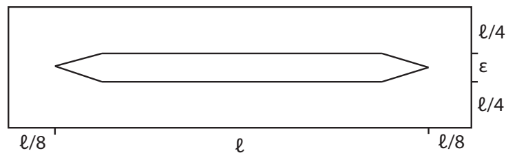
Abbildung 7.17: Geometrie für das allgemeine Test-Problem. Dabei bezeichnen \epsilon und \ell die Dicke und Länge der Kluft.
