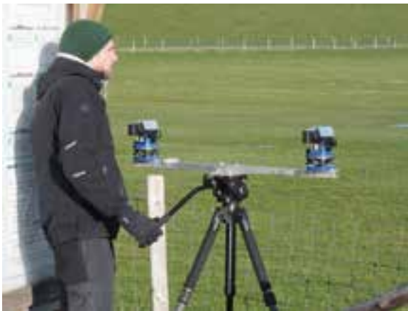
Abb. 1: Ein achsparalleles Stereosystem mit zwei Videokameras erwies sich für die Entfernungsbestimmung fliegender Vögel unter Freilandbedingungen als wenig geeignet.
