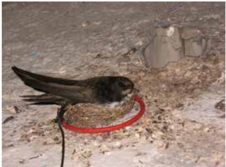
Abb. 1: Ruhender Mauersegler im Nest. Um die Anwesenheit eines Altvogels mit einem RFID-Transponder festzustellen, wurde eine Ringantenne um das Nest gelegt. Rechts im Hintergrund ist die Einflugöffnung zu erkennen.
