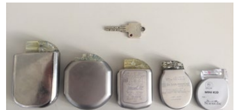
Seit 1992 sind das Gewicht der Defibrillatoren von 197 g auf 60 g und das Volumen von 113 ml auf 26 ml gesunken.
