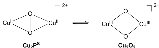
Schema 1. Isomerisierungsgleichgewicht zwischen \text{Cu}_2\text{P}^{\text{S}} und \text{Cu}_2\text{O}_2 .
