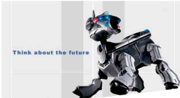
Tastsensoren am Kopf, am Rücken, im Gesicht, vier Pfotensensoren und drei am Schwanz, hat 16 Freiheitsgrade, eine Funkschnittstelle und kann durch die Kombination von 2D-Farbkamera und IR-Abstandsensoren dreidimensional sehen.
