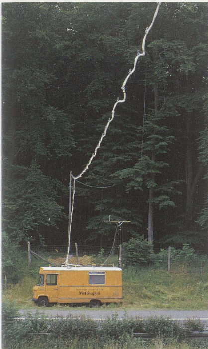
Abb. 5: Meßanordnung mit Schlauchbaum und Gittermasten zur experimentellen Bestimmung von Immissionsfeldern der Autoabgase an der Babenhäuser Landstraße im Frankfurter Stadtwald. Steuerung und Datenerfassung erfolgt bei den Messungen durch einen im Meßwagen des Zentrums für Umweltforschung der Frankfurter Johann Wolfgang Goethe-Universität befindlichen Computer.
