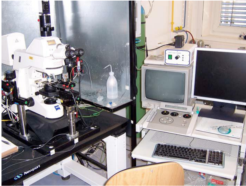
Abbildung 2.8: Der Elektrophysiologische Messstand. Links Mikroskop auf schwingungs- gedämpftem Tisch mit Badkammer, Mikromanipulator und Lichtquelle; rechts Steuerungseinheit für Mikromanipulator, Kontrastverstärker und Licht, Bildschirm für die Mikroskopausgabe und PC zur Datenerfassung.
