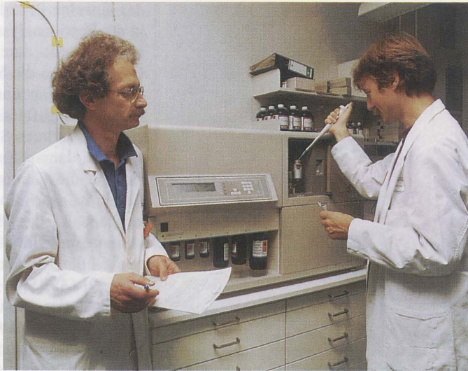
Die Aminosäureabfolge der aufgetrennten Peptide wird von Professor Dr. Hans-Georg Rammensee und Dr. Stefan Stevanović in einem Peptidsequenziergerät analysiert.
