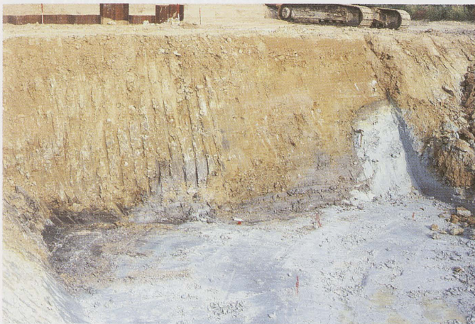
Abb. 8: Mergelaufpressung an der Straßenbrücke zwischen Weilbach und Bad Weilbach: Über dem hellen Mergel liegen eine dünne Schicht schwarzen Mergels, brauner Kies und Lösslehm. Rechts im Bild ist der Mergel infolge Wasserübersättigung (Gewichtsverminderung) in die Deckschichten aufgestiegen und hat dabei randlich den schwarzen Mergel mitgezogen. Diese Aufpressung liegt über dem Westrand des Oberheingrabens.
