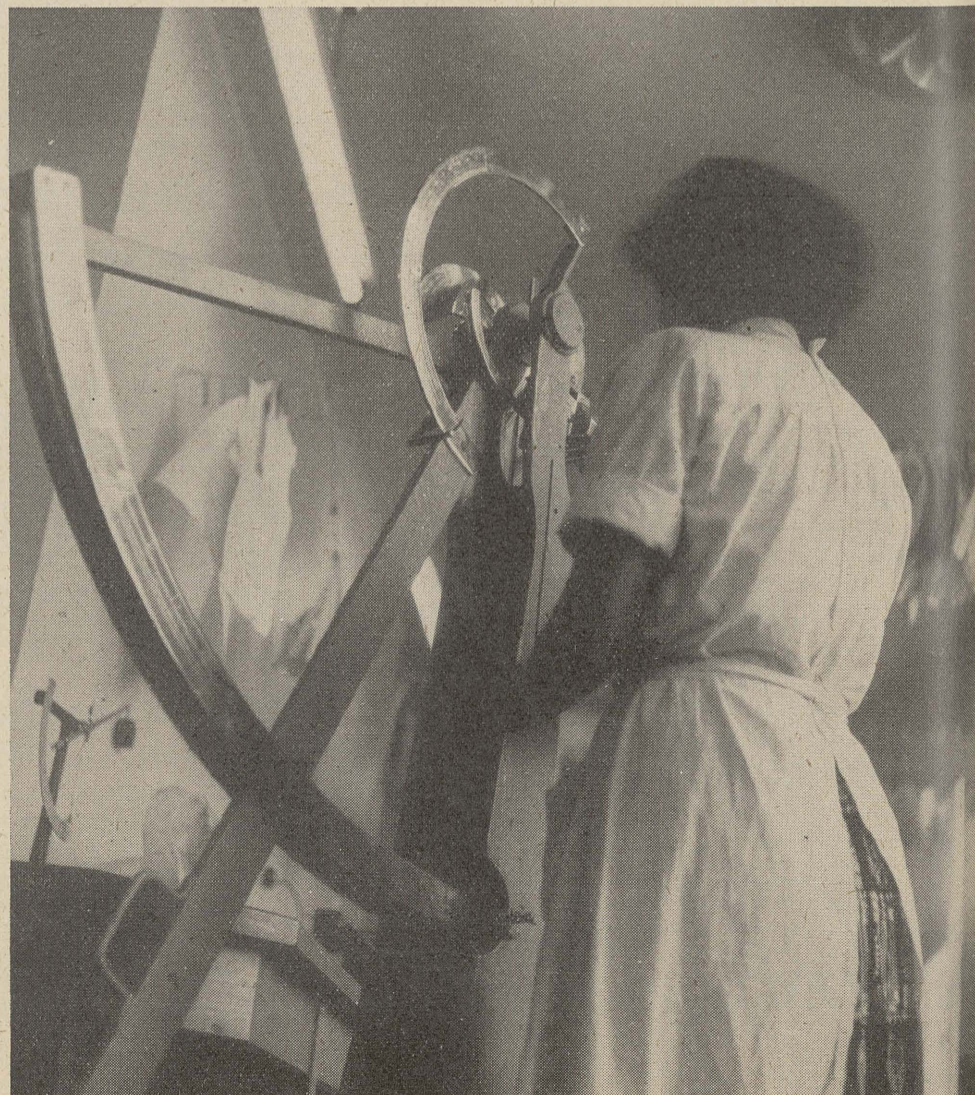
DAS INSTITUT FÜR PAPIERFABRIKATION an der TH — Darmstadt ist das einzige Instiut in Deutschland, an dem Papieringenieure auf Hochschulbasis ausgebildet werden. Das Modell einer Papiermaschine hat auf einem Tisch Platz, die Maschine selber ist 30 Meter lang. — Im Laboratorium mit Klimaanlage prüft eine Studentin — die an der TH übrigens Seltenheitswert besitzen — die Festigkeit des im Institut hergestellten Papiers (Bild unten).
