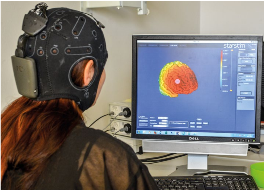
Die Probandin trägt die Stimulationshaube. Auf dem Bildschirm sieht man eine Visualisierung der Elektrodenposition
