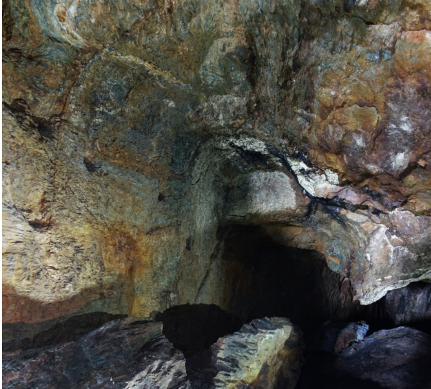
Abb. 13. Blick in das Berginnere mit einer weiteren Abstufung und den Lampennischen im nordöstlichen Stoss. Rechts das abgebrochene Gebirge. Foto R. Wahl-Clerici.
