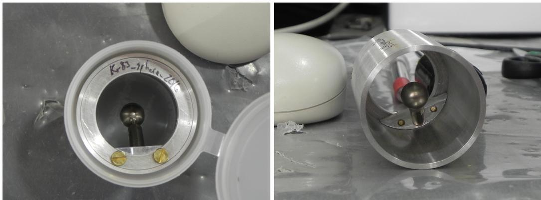
Abbildung 4.3: Fotos der  $^{83}\text{Kr}$ -Probe im Probenhalter.
