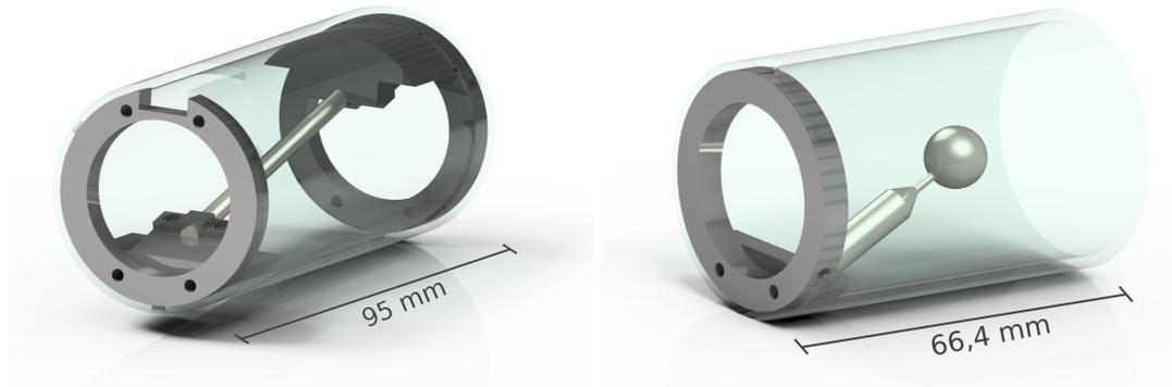
Abbildung 4.1: Links: Computerrender des  $^{85}\text{Kr}$  Probenhalters mit Probe. Rechts: Computerrender des  $^{83,86}\text{Kr}$  Probenhalters mit Probe.
