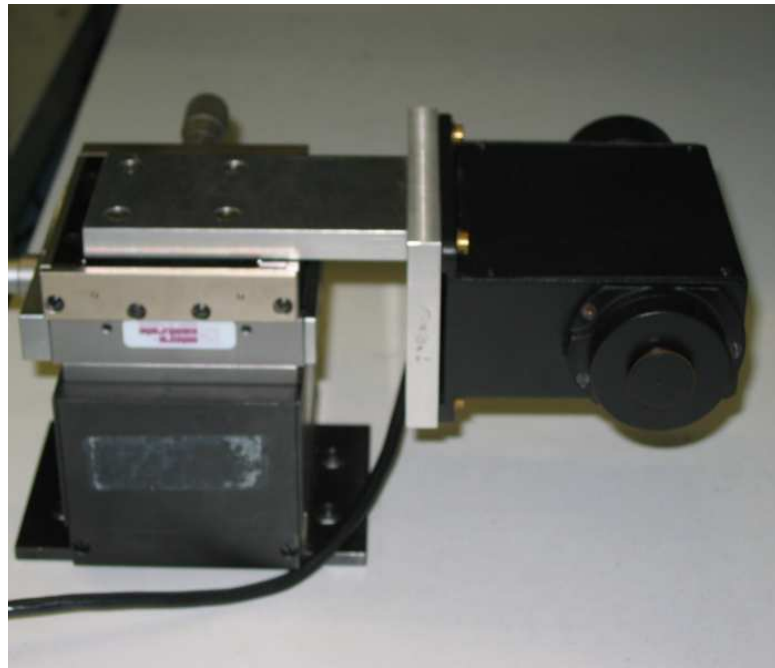
Abbildung 3.5: Foto der verwendeten Golay-Zelle in Halterung zur Justage.
