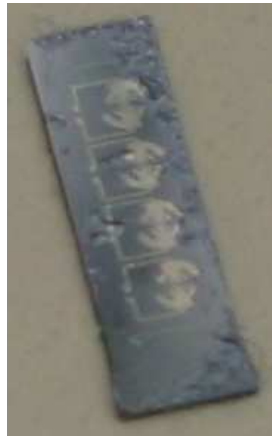
Abbildung 3.2: Foto einer in dieser Arbeit vermessenen Probe. Ihre Größe ist 3 \text{ mm} \times 10 \text{ mm} .
