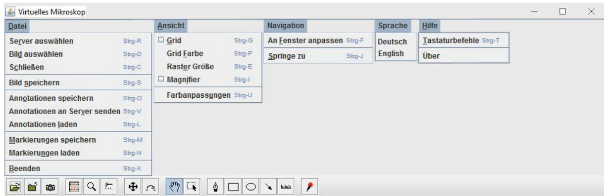
**Abbildung 2:** Der erste Hauptbereich der Programmoberfläche ist der Kopfbereich mit Menü- und Werkzeugleiste (Toolbar). Die obere Menüleiste ist in fünf Reiter (Datei, Ansicht, Navigation, Sprache und Hilfe) unterteilt. Die darunterliegende Toolbar erlaubt einen Schnellzug.
