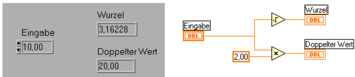
Abb. 8.1 Ein einfaches LabVIEW Programm, bei dem zu einer eingegebenen Zahl sowohl die Wurzel als auch das Doppelte der Zahl ausgegeben werden. Auf der linken Seite ist die Benutzeroberfläche zu sehen, auf der rechten Seite das dazugehörige Programm.
