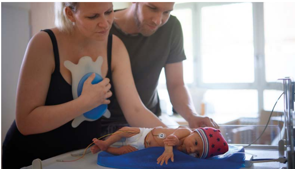
Ein Teil des Babybe-Systems wird auf die Brust eines Elternteils gelegt und überträgt deren Atembewegungen, Herzschlag und Stimme per Funk an die Matratze, auf der das Kind liegt.
