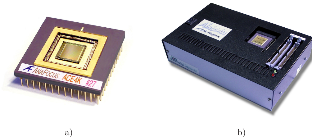
Bild 8.2: CNN-Hardware: a) CNN-Chip ACE4K von IMSE-CNM, Sevilla (Spanien), b) CNN-Plattform von Analogic Computers Ltd., Budapest (Ungarn)
