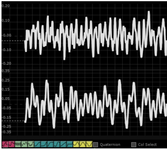
Audiosignal (stereo) der Eingabemusik. Pro Zeitschritt wird die Mischung der in der Musik enthaltenen Töne abgebildet (Sample). Eine Fourier-Transformation erlaubt das Differenzieren der ursprünglichen Tonfrequenzen in dieser Mischung.
