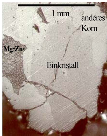
Abbildung 6.17: Einkristallines Korn der Zn_{70}Mg_{14}Y_{16} A-Phase im Polarisationsmikroskop
