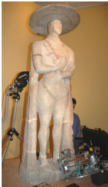
Fig. 30 Analisi condotta mediante strumentazioni portatili XRD e XRF per la caratterizzazione del colore e dei prodotti superficiali di degrado.
