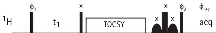
Abbildung 43: SIAM-TOCSY.  $\phi_1$ : TPPI,  $\phi_2=x,-x,y,-y$  und  $\phi_{rec}=x,-x,y,-y$  für (ZQ)-Selektion,  $\phi_{rec}=x,-x,-y,y$  für (DQ)-Selektion.
