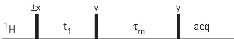
Abbildung 24: Schematische Darstellung der NOESY Pulssequenz.
