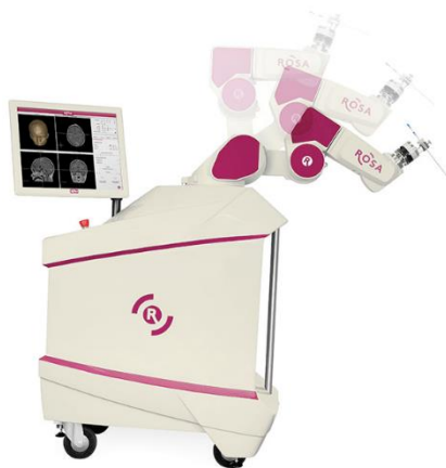
Abb. 4: ROSA-Roboter mit Steuerungseinheit und hydraulischem Arm (Bildnachweis: Zimmer Biomet Robotics, Montpellier, Frankreich)
